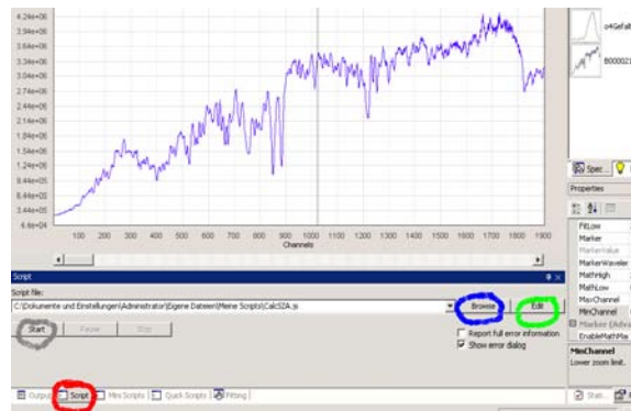
Abbildung 9.3: Das Script - Register. Durch Drücken des Buttons Browse können Scripten eingelesen werden. Der Quelltext wird durch betätigen des Buttons Edit in einem Editor angezeigt. Gestartet werden die Scripten durch Drücken des Buttons Start.
