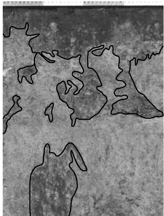
Abbildung 1: Ergebnis eines Färbeexperimentes mit Brilliant Blue an einer Parabraunerde bei Orleans.
